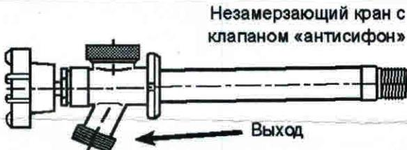
В дополнение к защите от замораживания, кран защищён от возможного поступления воды с уличной стороны, через подсоединеный к нему шланг. Для этой защиты в конструкции крана предусмотрен клапан «антисифон».
