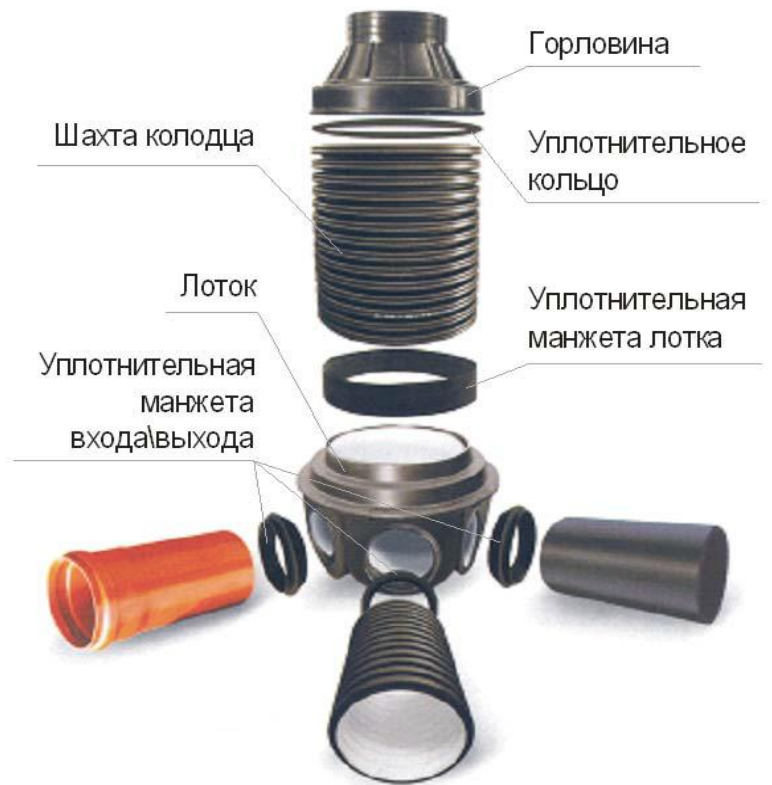
Конструкция сборного колодца
